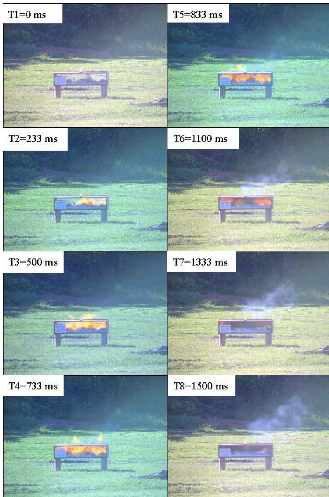
照片六. 1000 公升模擬置物箱正式試驗(六)
