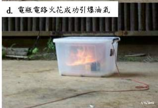
照片一. 96 公升模擬置物箱先期試驗(一)，汽油濃度高於爆炸下限兩倍，有氣爆現象，產生大火團，但無法持續燃燒
