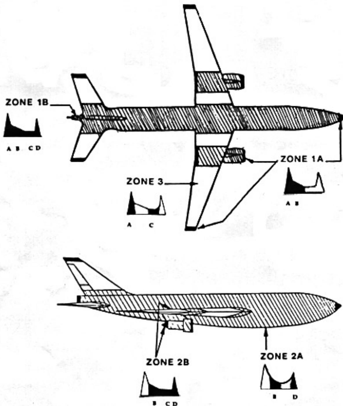
**FIGURE 2 LIGHTNING STRIKE ZONES (TYPICAL)**
